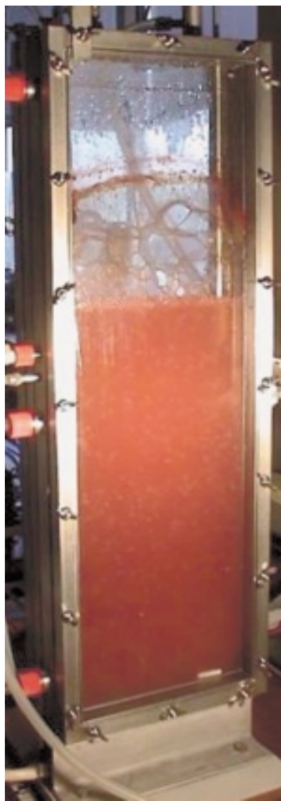
Figura 2 - Fotobioreattore da laboratorio per la produzione di idrogeno da batteri rossi.
